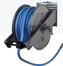
Enrouleur INOX Enrouleur automatique inox, tuyau Ø 12, longueur 20 m + 2 m d'alimentation, support mural pivotant H0050012
